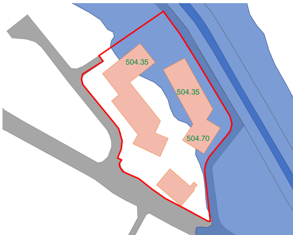
Abbildung 6: Skizze mit Projektperimeter (rot), potentieller Überflutungsfläche (blau) und Empfehlung von EHQ-Schutzkoten [m ü.M.] (grün)
