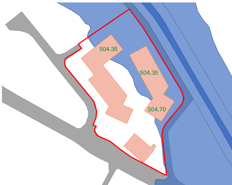
Abbildung 6: Skizze mit Projektperimeter (rot), potentieller Überflutungsfläche (blau) und Empfehlung von EHQ-Schutzkoten [m ü.M.] (grün)
