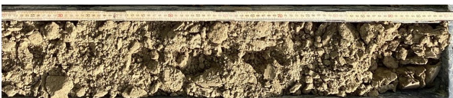
Abbildung 4: Glaziale Seeablagerung von 2.2-3.0 m Tiefe unter Terrain aus RKB 23-1/P.
