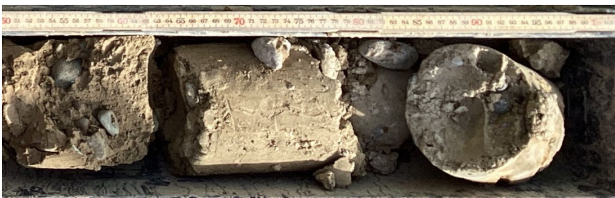
Abbildung 6: Moräne von 5.5-6.0 m Tiefe unter Terrain aus RKB 23-1/P.
