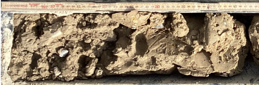
Abbildung 5: Aufgelockerte Moräne von 5.0-5.4 m Tiefe unter Terrain aus RKB 23-1/P.
