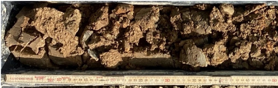
Abbildung 3: Schwemmsediment von 1.0-1.5 m Tiefe unter Terrain aus RKB 23-1/P.
