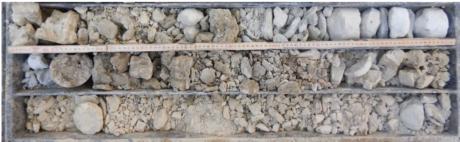
Abbildung 7: RKB 20-2. 12.0 – 15.0 m: Molassefels (Obere Süsswassermolasse, OSM).
