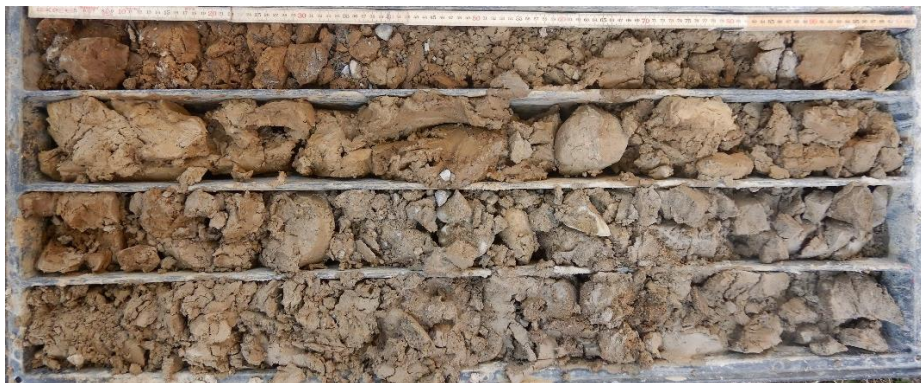
Abbildung 3: RKB 20-2. 1.0 – 3.8 m: Schwemmsediment; ab 3.8 m: Seeablagerung, glazial.
