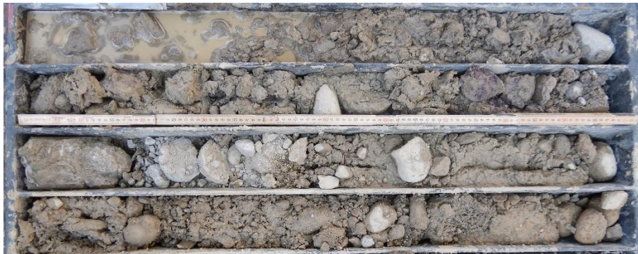
Abbildung 5: RKB 20-2. 5.0 – 5.6 m: Seeablagerungen, glazial; 5.6 – 9.0 m: Moräne, aufgelockert.
