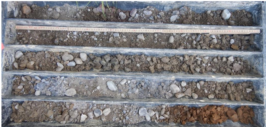
Abbildung 2: RKS 20-3. 0.0 – 4.6 m: künstl. Auffüllung; ab 4.6 m: Schwemmsediment.
